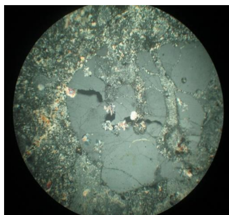
Рис. 3. Включения кварца в алунитизированном полевошпатовом агрегате.
